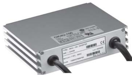
Fig. 6.2. Este microinversor de red de 100 W de potencia, prácticamente cabe en la palma de la mano, y posibilita convertir un módulo de 24 V en un generador de corriente alterna de 220 V, la cual puede ser inyectada en la red. (Cortesía de NKF KABEL B.V.).
